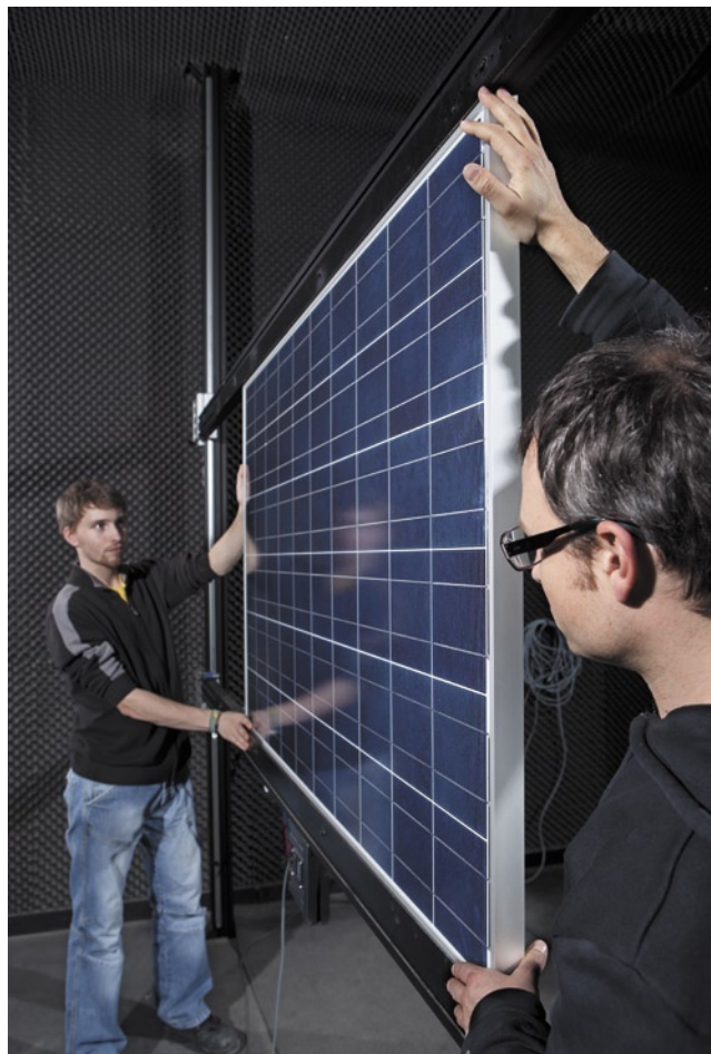
▲ Im Sonnensimulator hat das PHOTON-Labor das Schwachlichtverhalten der Module vermessen
